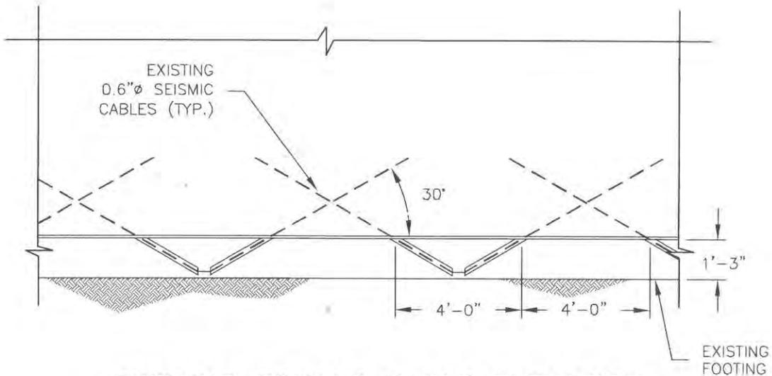
**EXISTING SEISMIC CABLE ELEVATION**
